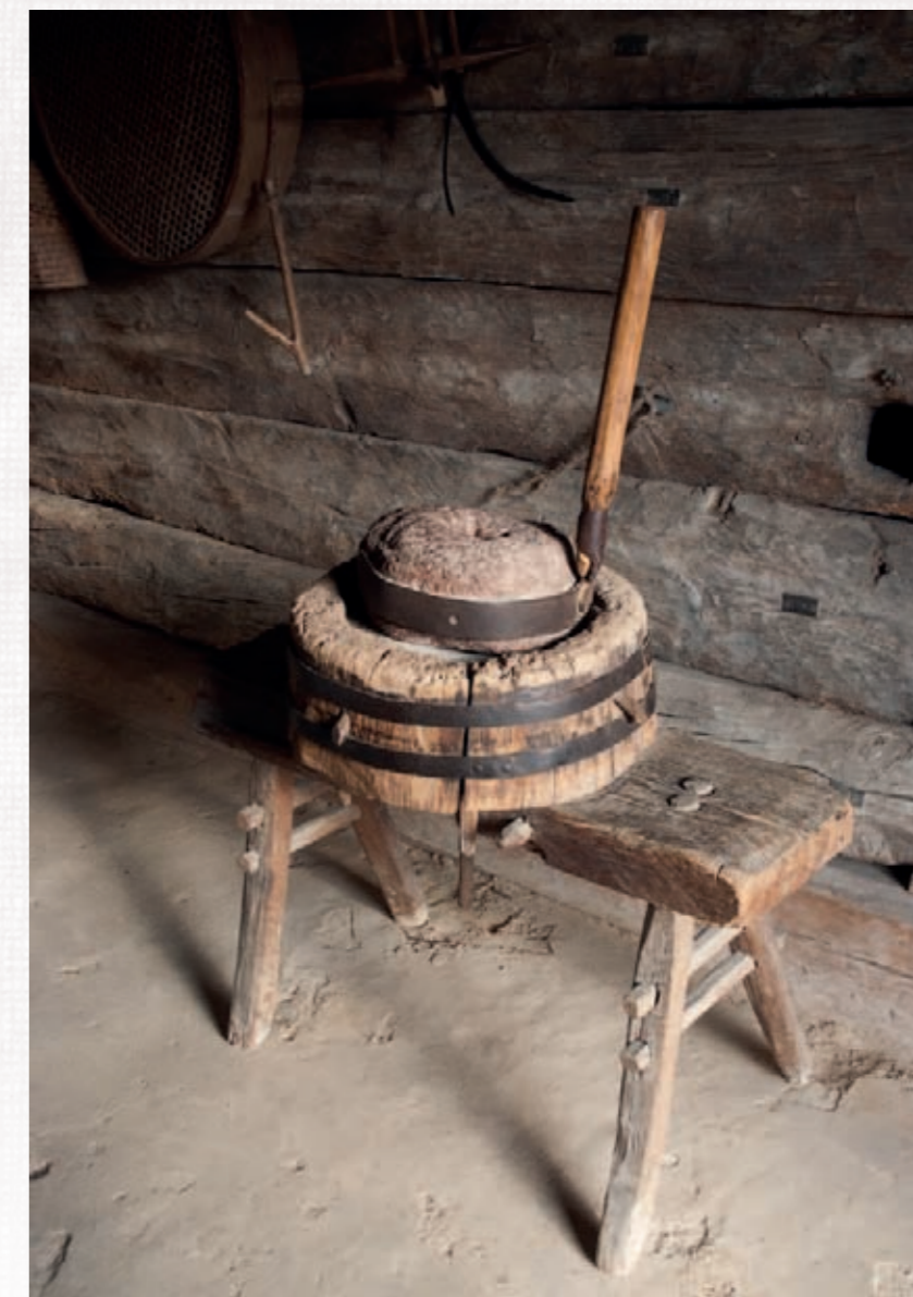
Żarna rotacyjne, leżak i biegun w obudowie wydrążonej z pnia, okucia kowalskie, średnica kamieni 42 i 49 cm, wytwórca nieznan, XIX w., Nowa Wieś, Chalupa z Tarnogóry, MWL/5034.
