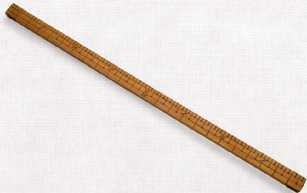
Przymiar łokciowy, drewniany, długość 1 łokieć (57,6 cm), wykonawca Andrzej Kuliński, 2015 r., gra edukacyjna Budujemy Lublin , rekwizyt.
